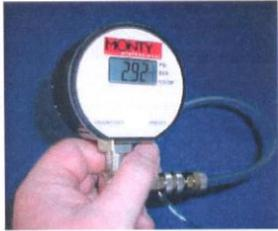
**Die Dichtheitsprüfung** erfolgt mittels Drucktest mit Spezialmanometern. Die Messgenauigkeit  $< 1$  mbar ermöglicht auch bei Kurzzeitmessungen exakte Erkennung von Leckagen. Oft ist dieses die erste Maßnahme zur Erkennung von Undichtigkeiten und zur Definition des betroffenen Systems. So kann sicher erkannt werden, ob ein druckführendes System betroffen ist.
