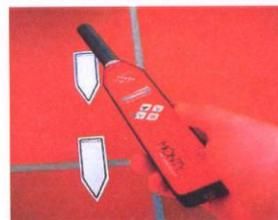
**Die Lage der Rohrleitung** ist wichtig für den Einsatz aller weiteren Messmethoden zur Schad-stellenauffindung, aber auch zur Herstellung von Öffnungen, damit Kabel und Rohre nicht beschädigt werden. Mit Ultraschallscannung und mit Sender und Empfänger werden alle Rohrleitungsverläufe erkannt und können markiert werden.
