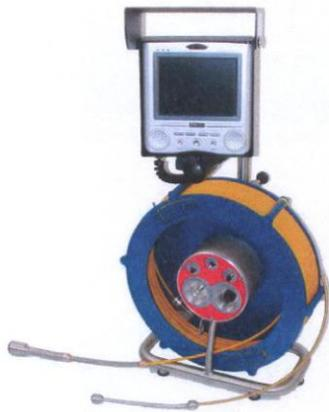
**Rohrkameras** mit Bildaufzeichnung werden zur Untersuchung der Abwassersysteme im Gebäude und für den Abwasserhausanschluss eingesetzt. Hiermit können Rohre ab der Dimension von 30 mm untersucht werden. Diese Kameras sind mit den neuesten CCD-Kameraköpfen ausgerüstet und liefern dadurch ein detailliertes Bild, wodurch Schäden und Ursachen genauestens beurteilt werden können.
