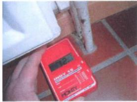
**Dielektrisch Feuchte messen** kann in der Eingrenzung des Schadens eine große Hilfe sein. Diese Methode ermöglicht beschädigungsfreies Erkennen von Feucht bis zu 4 cm unter Oberflächenbeschichtungen, wie z.B. unter Fliesen, Laminat oder Kunststoffbelägen.
