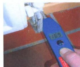
**Strömungsgeräusche** von Undichtigkeiten an Rohrleitungen welche unter Druck stehen, können mit Elektroakustischen Geräuschverstärkern oft perfekt erkannt werden. Diese Methode der Vorortung lässt oft den Schaden schon in kürzester Zeit eingrenzen. Die Hörbarkeit der Strömungsgeräusche wird bei Bedarf durch Einsatz von Druckluft oder Formiergas im System, statt Wasser, erhöht.
