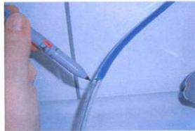
**Die Leckmengenmessung** ergibt zuverlässigen Aufschluss über den zu erwartenden Schadensumfang. Die Menge des austretenden Wassers wird präzise mit Leckmengenmessgeräten, oder mit Referenzflüssigkeit gemessen. Dieses ist wichtig um den Schaden in Umfang und Auswirkung einschätzen zu können. Der Messwert wird in der Dokumentation festgehalten und in Liter pro Tag angegeben.
