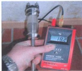
**Leitfähigkeitsmessung** ermöglicht die exakte Bestimmung der Baustofffeuchte im Verhältnis zum Baustoff bei perfekter fachkundiger Baustoffbestimmung. Im Mauerwerk und an Estrichrandstreifen erfolgt so einfache beschädigung-sarme Feuchtebeurteilung. Die wiederkehrenden Messungen ermöglichen so perfekte Überwachung des Trocknungsfortschritts und zeigt das Erreichen der Gleichgewichtsfeuchte.
