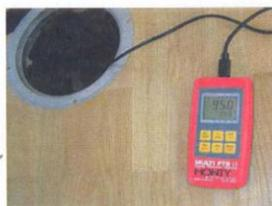
**Luftfeuchtemessung** zeigt die aktuelle Belastung der Raumluftfeuchte, aber auch die Feuchtigkeit in Hohlräumen, wie z.B. unter Duschen oder hinter Vorwandinstallationen. Auch zur Überwachung der Trocknungseffektivität ist diese Messung unerlässlich in der laufenden Bautrocknung.
