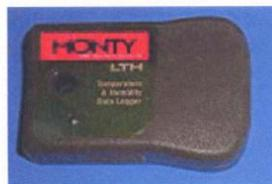
**Datenlogger** für Temperatur und relative Luftfeuchte ermöglichen eine perfekte und kaum manipulierbare Methode zur Messung des Raumklimas über Langzeit. Der Datenlogger eignet sich perfekt zur Überwachung von Räumen bei der Bautrocknung oder bei Schimmelpilzbefall zur Erkennung,
