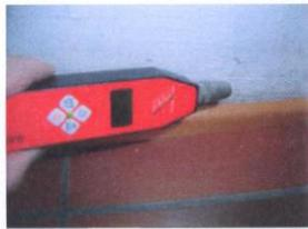
**Das Gasprüfverfahren** gilt als erfolgreichste Art der Leckortung. Hierbei wird das betroffene System vollständig entwässert und mit Formiergas gefüllt. Das Spezialgas dringt durch alle Fugen und Ritzen und durch Spezialbohrungen in der Nähe des Leitungsverlaufs. Die Erkennung der Schadstelle erfolgt durch Messung der Gaskonzentration ab 1 ppm.
