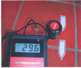
**Ultraschall** kann von uns mit Formiergas an der Schadstelle erzeugt werden. Dieses ermöglicht in Folge die Messung der Ultraschallausbreitung mit speziell hierfür konzipierten Ultraschalleckortungsgeräten. Hierdurch kann oft der Schaden punktgenau geortet werden, auch wenn hohe Geräuschemissionen wie z.B. im Mehrfamilienhaus oder in gewerblich genutzten Objekten vorliegt.
